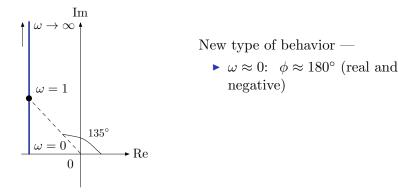
$$G_2(j\omega) = \frac{j\omega - 1}{j\omega + 5} = \frac{1}{5} \frac{j\omega - 1}{\frac{j\omega}{5} + 1}$$
