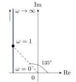
$$G_2(j\omega) = \frac{j\omega - 1}{j\omega + 5} = \frac{1}{5} \frac{j\omega - 1}{\frac{j\omega}{5} + 1}$$
