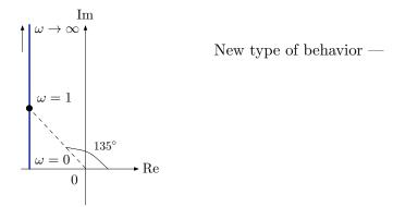
$$G_2(j\omega) = \frac{j\omega - 1}{j\omega + 5} = \frac{1}{5} \frac{j\omega - 1}{\frac{j\omega}{5} + 1}$$
