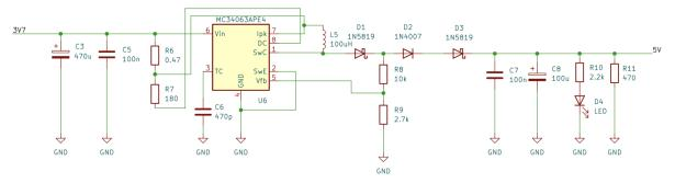
Figure 2.3.1.2 Voltage Boost Converter
