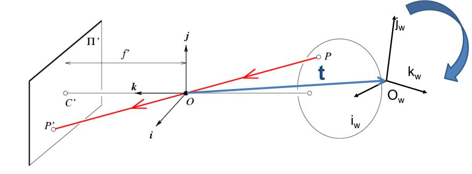
$$\mathbf{X} = \mathbf{K} \begin{bmatrix} \mathbf{R} & \mathbf{t} \end{bmatrix} \mathbf{X} \Rightarrow w \begin{bmatrix} u \\ v \\ 1 \end{bmatrix} = \begin{bmatrix} f & s & u_0 \\ 0 & \alpha f & v_0 \\ 0 & 0 & 1 \end{bmatrix} \begin{bmatrix} r_{11} & r_{12} & r_{13} & t_x \\ r_{21} & r_{22} & r_{23} & t_y \\ r_{31} & r_{32} & r_{33} & t_z \end{bmatrix} \begin{bmatrix} X \\ Y \\ Z \\ 1 \end{bmatrix}$$
